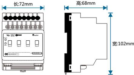
图2. 尺寸图-正面
