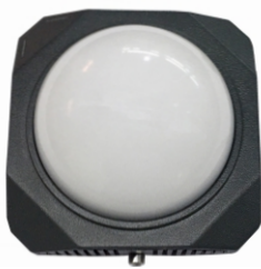
图1. 室外光照度感应模块
