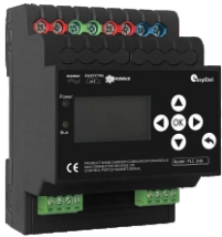
图1. PLC电力载波模块
