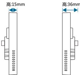
图5. 尺寸图-左侧
