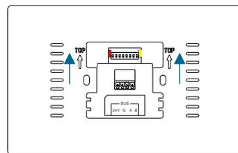
图11.安装方向
